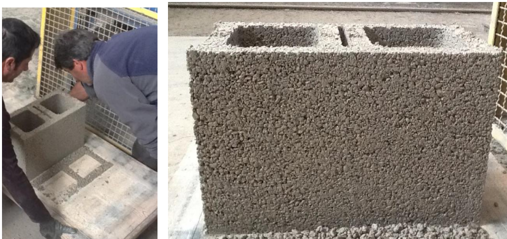
Figura 4. Alcune prove di prefabbricazione di un blocco strutturale formulato con l'utilizzo di anidrite sintetica.
