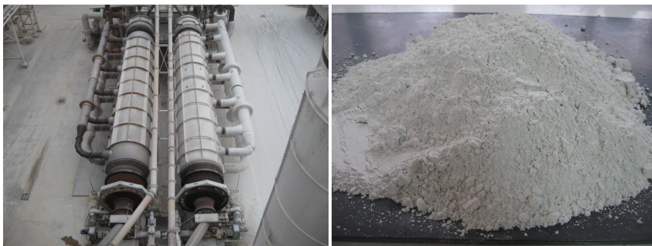
Figura 1. A sinistra, due linee di produzione dell'acido fluoridrico gas; a destra, un particolare dell'anidrite "sintetica" al termine del processo di macinazione.
